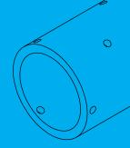
Conçus pour la collecte de biogaz et de lixiviat dans des sites d'enfouissement, nos tuyaux perforés sont fabriqués de polyéthylène haute densité selon nos hauts standards de qualité. Avec un patron de trous disponible en plusieurs diamètres permettant d'optimiser la collecte des gaz et des liquides, ce produit éco-responsable, robuste et durable est disponible en diamètres de 4, 6 ou 8 pouces et en plusieurs formats et longueurs.
